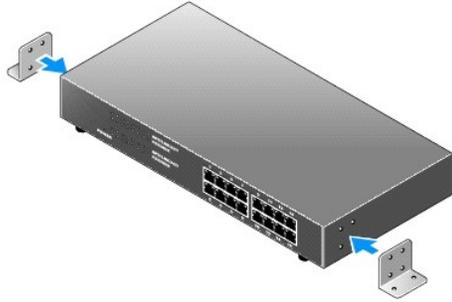
3. Halten Sie den Switch gegen die Wand, und markieren Sie die Position der Haltelöcher auf der Wand.
